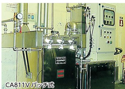
CA-811 シリーズは、1日 30ℓ～80ℓ程度の廃液量のお客様に適応した、バッチ式の蒸留再生装置です。蒸留釜へは、真空の吸引力を利用して対象液を投入が出来ます！！
